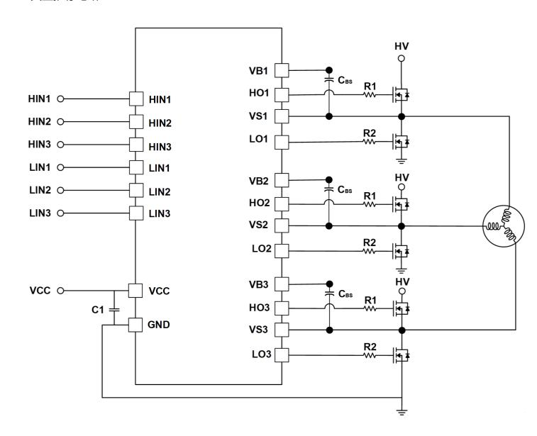
图 2. 无刷电机驱动参考电路
