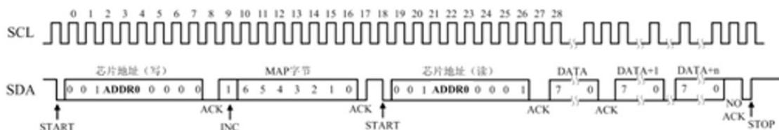
图五、控制端口时序（I<sup>2</sup>C 从模式读）
