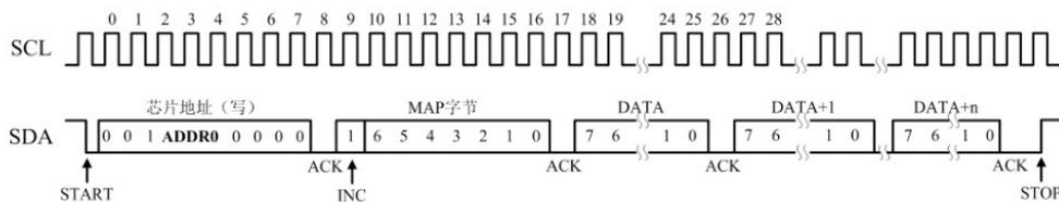
图四、控制端口时序（I<sup>2</sup>C 从模式写）
